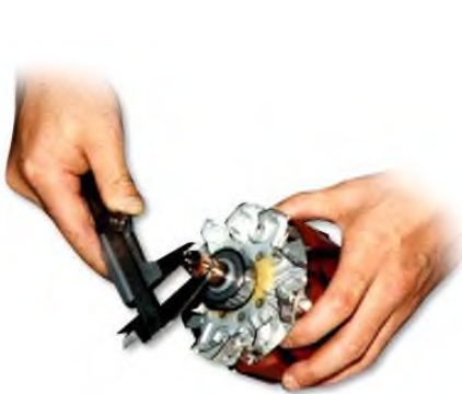
Hình 1.15 Kiểm tra vòng tiếp điện
