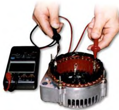
Hình 1.16- Kiểm tra thông mạch Stator
